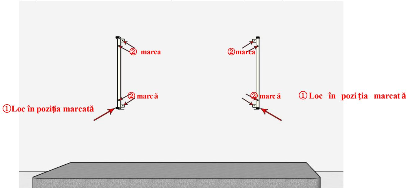
În funcție de marcajele găurilor, faceți găuri în perete și instalați tuburile de dilatare. Apoi puneți cadrul de susținere înapoi pe perete și fixați toate cele 8 dopuri de dilatare. Verificați dacă distanța dintre cele două rame de susținere de la sol este aceeași. Dacă distanțele sunt diferite, puteți slăbi șurubul dopului de expansiune pentru ajustare. După fixare, instalați bușonul în orificiul de pe cadrul de susținere.
