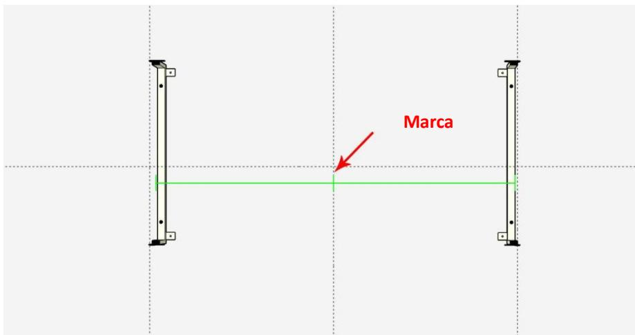
Plasați două tablouri albe între fittingurile pliabile superioare și inferioare și fixați-le cu șuruburi sau nituri. Puteți instala mai întâi o tablă albă și aliniați poziția centrală cu linia de marcă a punctului central înainte de a o fixa. Atunci când instalați o altă tablă albă, îmbinările superioare și inferioare și de mijloc ale celor două tablouri albe sunt aliniate și fixate.
