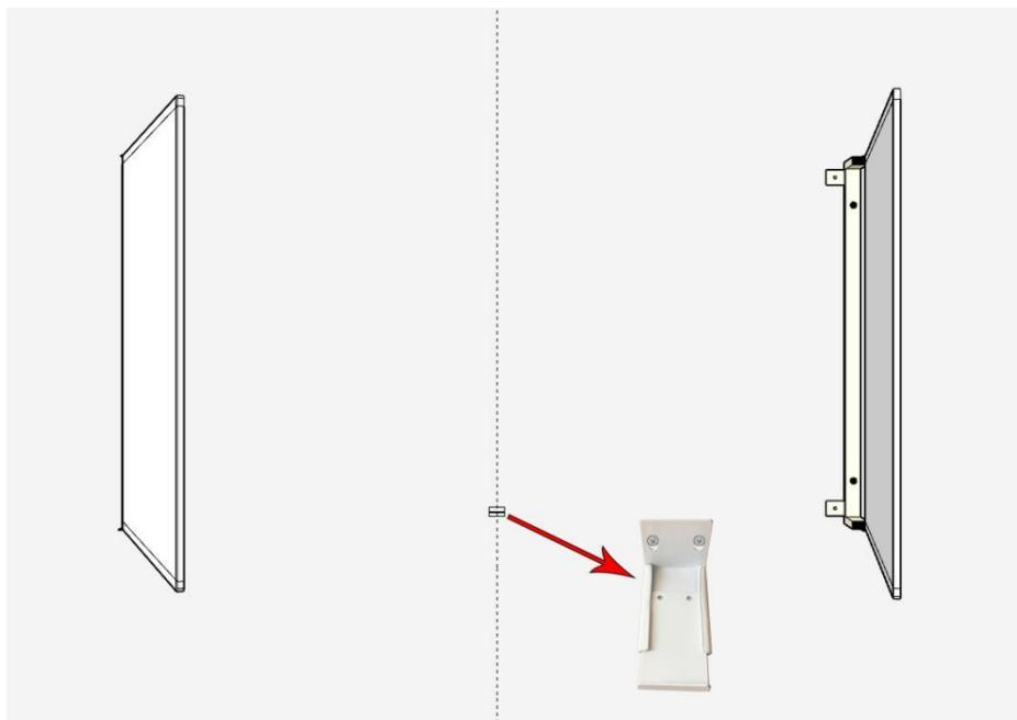
6. Instalați magnetul (după ce cele două plăci sunt închise, partea de jos a poziției de contact a suportului, respectiv instalați magnetul , închideți depanarea: în cazul în care umflarea de mijloc sau concavă poate regla placă de expansiune pe suportul de mijloc, reglați șurubul de pe placă de expansiune după ajustarea la poziția ideală).
