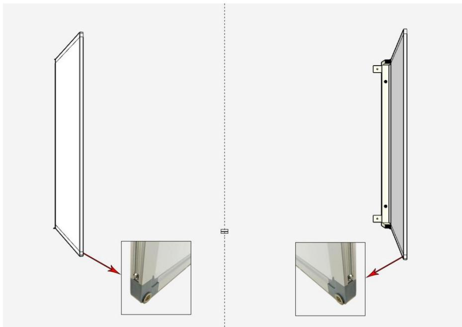
7.Instalarea este finalizată (verificarea deschiderii și închiderii dacă este normală, dacă există o abatere de poziție, deșurubați șuruburile sau niturile de pe părțile de pliere superioare și inferioare ale plăcii pentru a regla)
