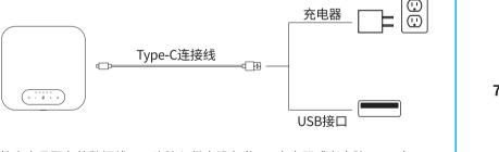
将本产品配备的数据线USB头接入供电设备(如AC充电器或者电脑USB口), 另一端接入本产品Type-C输入端口,即可给本产品充电。
